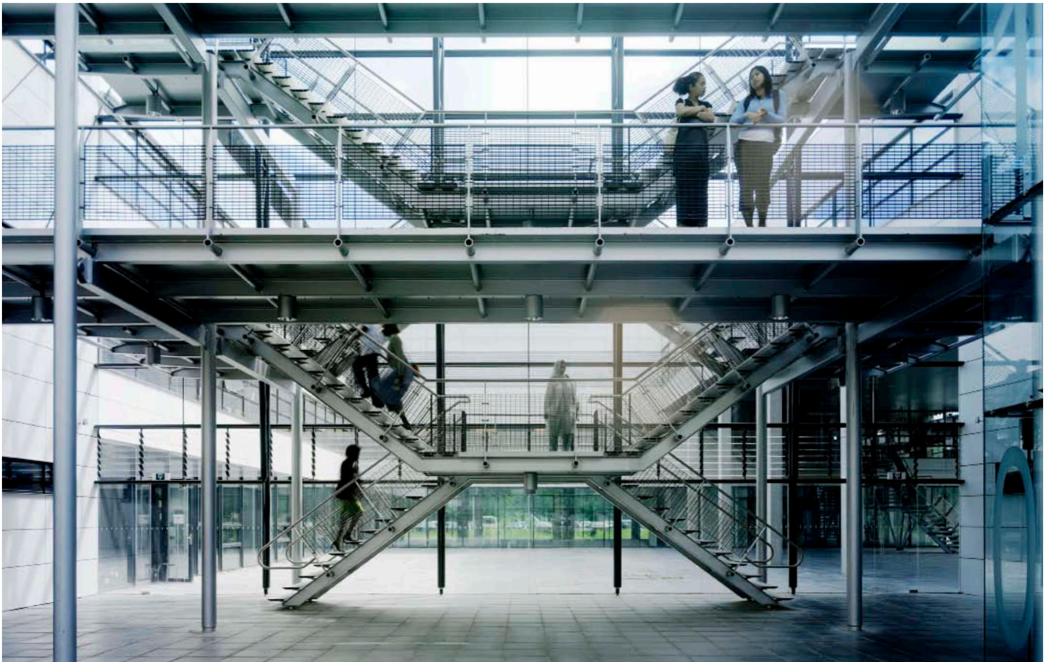
Om het open karakter van het openbare atrium niet te verstoren zijn trappen en liften uitgevoerd in staal en glas. So as not to detract from the open character of the public atrium, stairs and lifts are executed in steel and glass.
