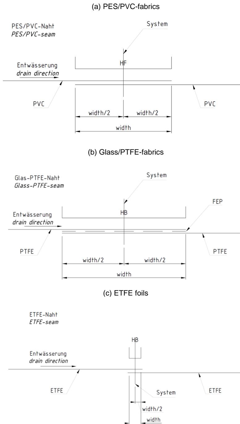
Figure 8-2 Typical exemplary welded seams of coated fabrics and foils [source and ©: formTL ingenieure für tragwerk und leichtbau GmbH]
