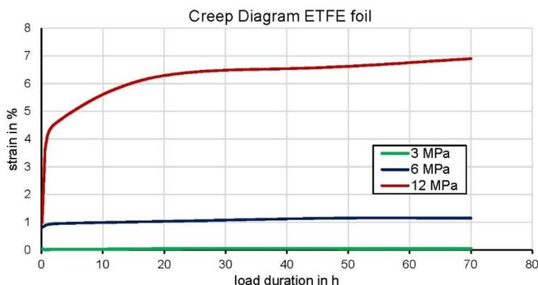
Figure 7-10 Typical creep diagram for an ETFE foil [source and ©: formTL ingenieure für tragwerk und leichtbau GmbH]
