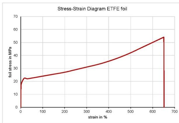
Figure 7-3 Typical stress strain diagram for an ETFE foil [source and ©: formTL ingenieure für tragwerk und leichtbau GmbH]
